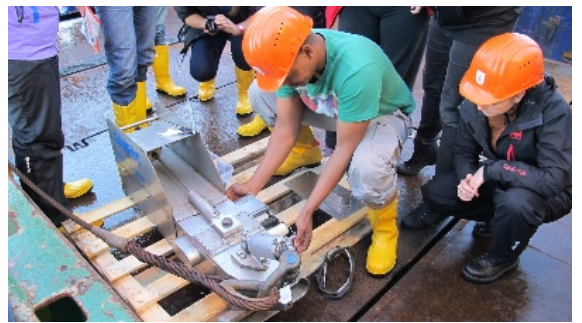
Instalación de un CPR (Registrador Continuo de Plancton)
